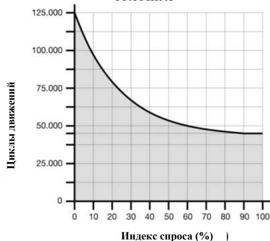
Пример расчета срока службы редукторного двигателя Wingo WG5024 (см. Таблицу 2 и график А):
